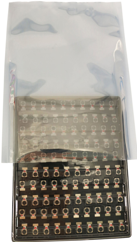
Coloque a bandeja no saco antiestático
